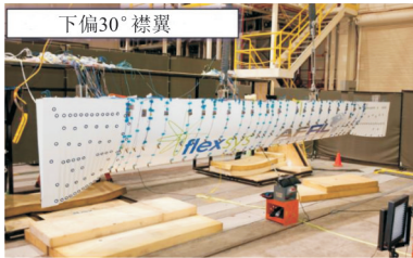
图 17 分布式柔性无缝变形后缘襟翼 Fig. 17 Distributed flexible morphing trailing edge flap
