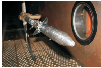
图 1 风洞试验模型安装图
