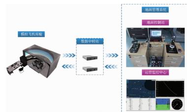
图 3 上海交通大学的“驾驶舱+地面站”SPO 组合方案演示和验证系统架构<sup>[9]</sup>
