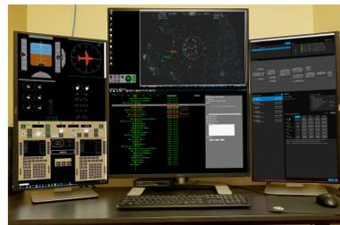
图 2 NASA SPO 实验模拟地面站<sup>[15]</sup>
