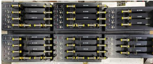
图 7 舱门作动系统模拟装置
