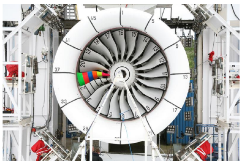
图 16 整机包容试验 [72]
