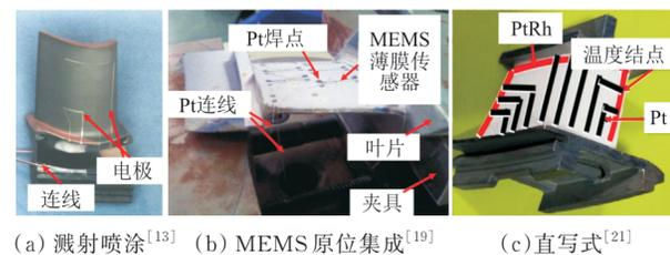
图2 不同制造工艺制备的薄膜热电偶
