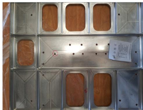
图 7 基准安装板的减轻孔位置
