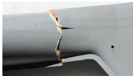
图 11 桨叶蒙皮断裂 Fig. 11 Blade skin fracture
