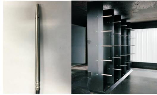
图 4 总温探针和温度格栅
