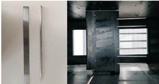
图 2 方向动压组合探针和装置
