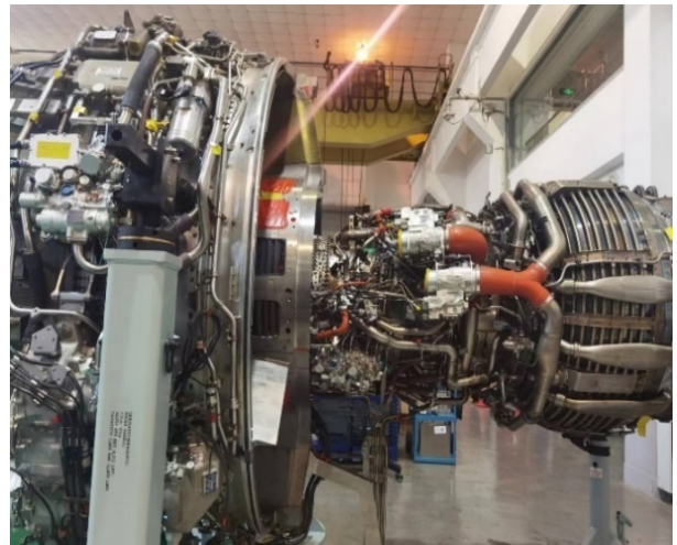
图 1 航空发动机燃油管路系统实物图
