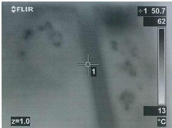
图5 红外热像检测复合材料
