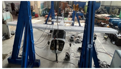
图 3 XL100 飞机地面振动试验验证平台 Fig. 3 XL100's ground vibration test verification platform
