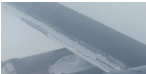
图 10 探测飞行机翼结冰情况(2021年2月24日) Fig. 10 Detection of icing on flight wings (2021-02-24)
