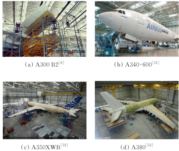
图 1 ONERA/DLR 全机地面共振试验现场 Fig. 1 ONERA/DLR full aircraft ground vibration test
