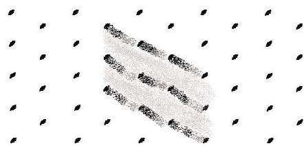
图 2 发散小孔冷却结构示意图
