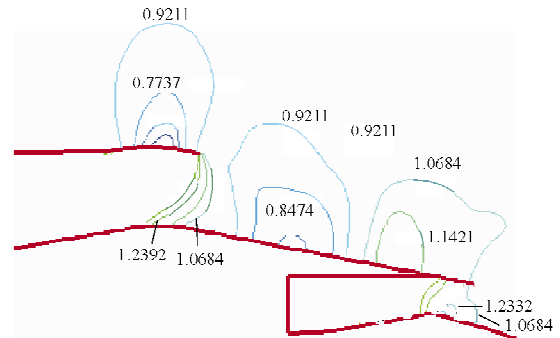
图 3 流场中无量纲静压 p/p_0 分布
