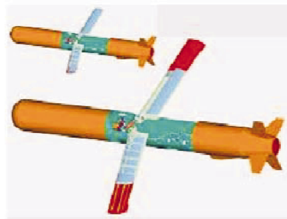
图 3 雷神公司的伸缩机翼试验模型 Fig. 3 Telescopic wing model designed by Raytheon
