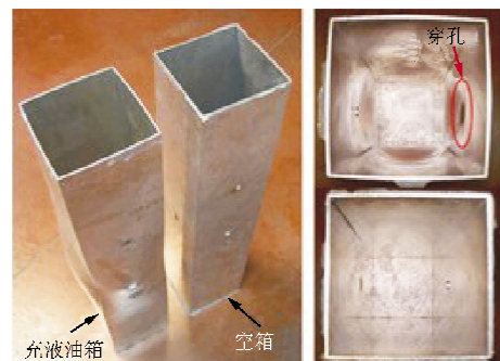
(b) 空箱和充液油箱壁板变形情况对比
