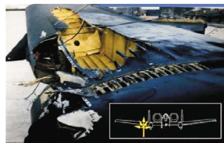
图 3 机翼翼盒在水锤效应作用下的破坏形式 Fig. 3 Destory mode of wing tank under the influence of hydrodynamic ram
