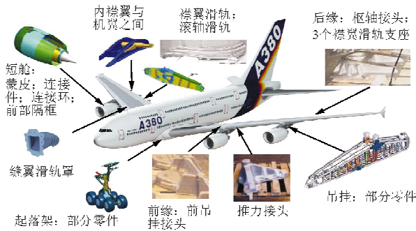
图 6 钛合金在 A380 飞机上的主要分布
