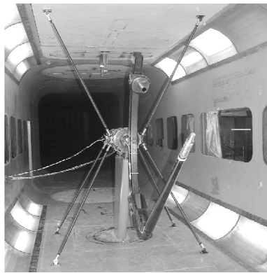
图 3 旋转天平试验装置风洞安装图
