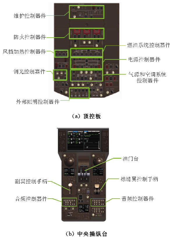
图6 某民航驾驶舱顶控板和中央操纵台控制器件布置设计
