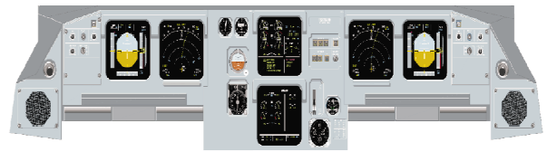
图 2 A320 主仪表板内的显示控制设备
