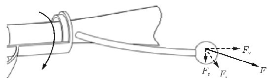
图 4 螺旋桨转速增加时离心锤的受力分析
