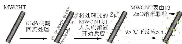
图 2 MWCNT 表面生长 ZnO 纳米颗粒示意图 Fig. 2 Schematic illustration of ZnO nanoparticle immobilizing on MWCNT
