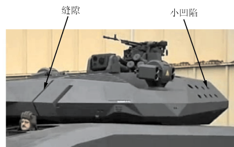
图 2 某隐身坦克表面电磁缺陷
