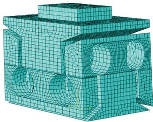
(c) 同转动中心圆弧切面双向柔性铰链
