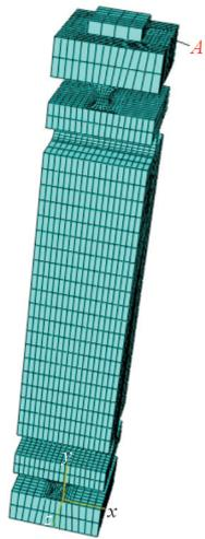
图 6 双圆弧柔性梁的有限元模型
