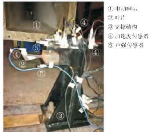
图 4 叶片试验系统
