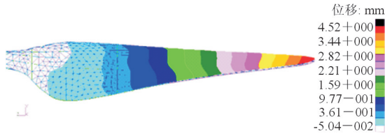
图 10 样本 1 桨叶位移云图 Fig. 10 Blade displacement of sample 1
