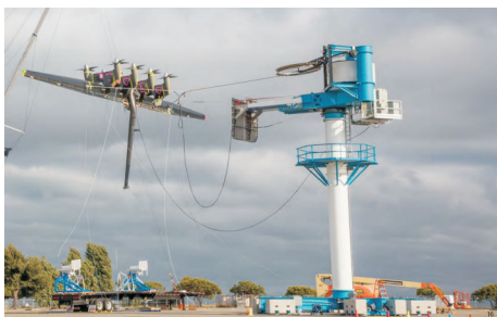
图 6 Makani Power 的 M600 正在进行悬停实验
