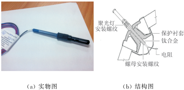
图 2 结冰探测棒 Fig. 2 Icing indicator
