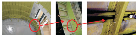
(a) 铝合金飞机结构强化
