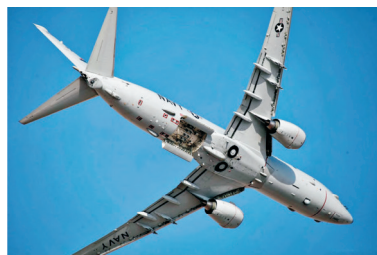
图3 P-8A机身弹舱和翼下挂点
