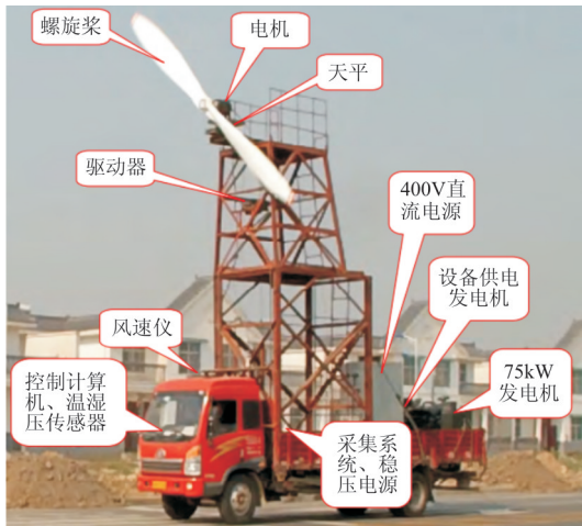
图 11 CFJ 技术在螺旋桨上的应用
