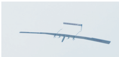
图1 太阳能飞机飞行试验中的机翼反对称颤振
