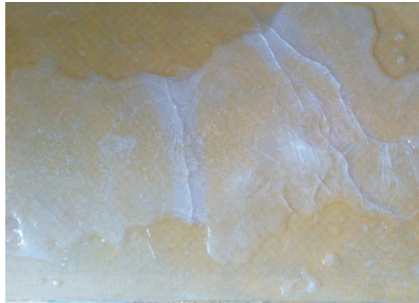
图 7 加热垫表面人工结冰效果
