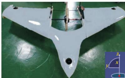
图 1 某型垂直起降固定翼无人机工程样机
