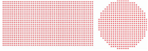
图3 鸟体SPH模型
