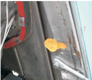
图 11 某框受腐蚀实物图
