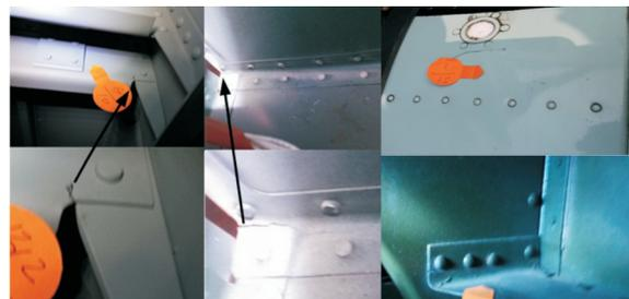
图 1 典型结构开裂形式
