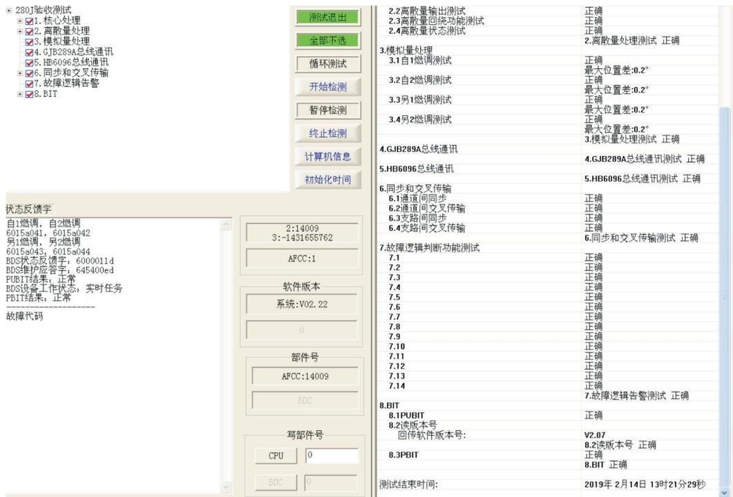
图 9 自动飞行控制计算机全项目自动测试故障逻辑和 BIT 检测结果
