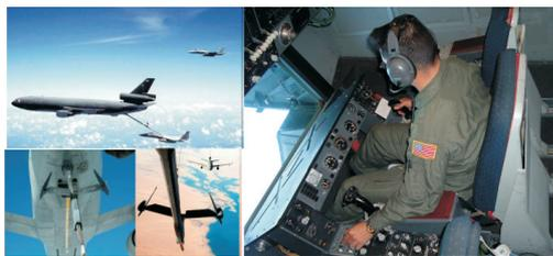
图4 KC-10加油机及其硬式空中加油装置
