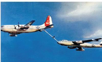
图 2 第二代硬式空中加油机(KC-97)
