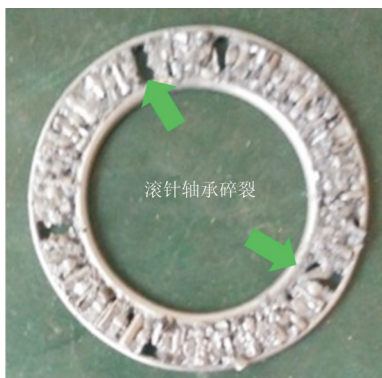
图 13 滚针轴承碎裂
