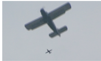
图 7 载机投放自由飞试验
