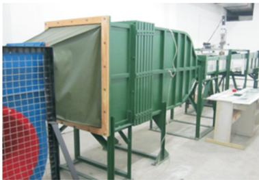
图 1 小型下吹式边界层风洞
