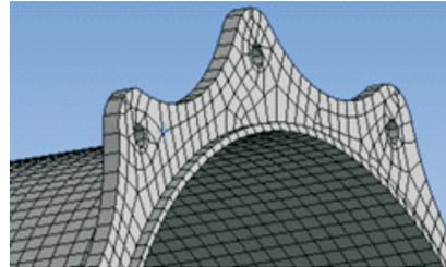
图 4 机匣精细有限元模型法兰凸缘结构
