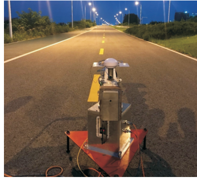
图 5 ArcSAR FOD 监测雷达原理验证平台外场试验照片 Fig. 5 Photos of field test of principle verification platform
