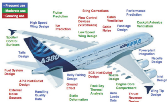
图 12 CFD 技术在 A380 研发过程的应用
