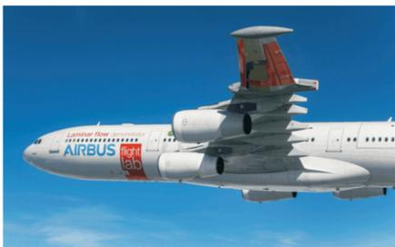
图4 空客A340 BLADE飞行测试<sup>[27]</sup>
