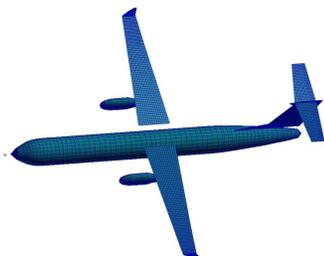
图2 全机气动力模型
