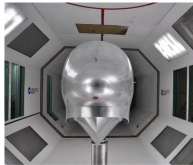
图1 风洞试验模型
